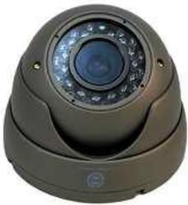
camara minidomo color - skyview® - ccd de 1/3" marca sony - resolucion de 540tvl - 28 iluminadores infrarrojos (30~45ft) - 0.1lux/f1.2 - lente varifocal de 4 - 9 mm - autoiris - voltaje 12vdc -ntsc
